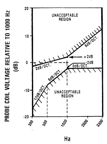
FIG 4B INDUCED VOLTAGE FREQUENCY RESPONSE FOR RECEIVERS WITH AN AXIAL FIELD THAT EXCEEDS  $-22\ dB$
